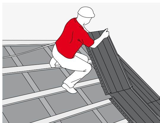
RYS. 27. UKŁADANIE KOLEJNEGO PANELU NA ZAKŁAD
