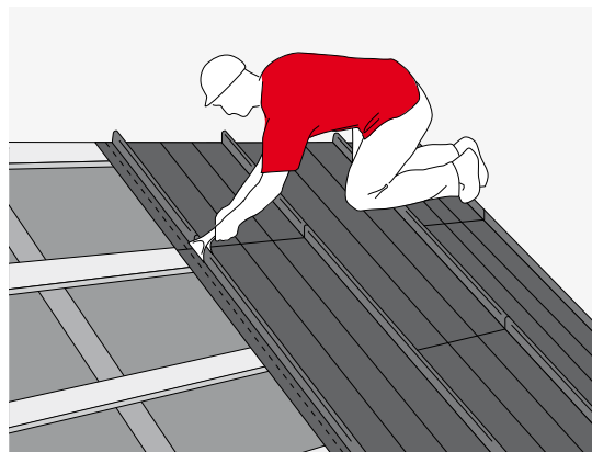
RYS. 30. ZACISKANIE ZAMKA PANELI W ZAKŁADACH
